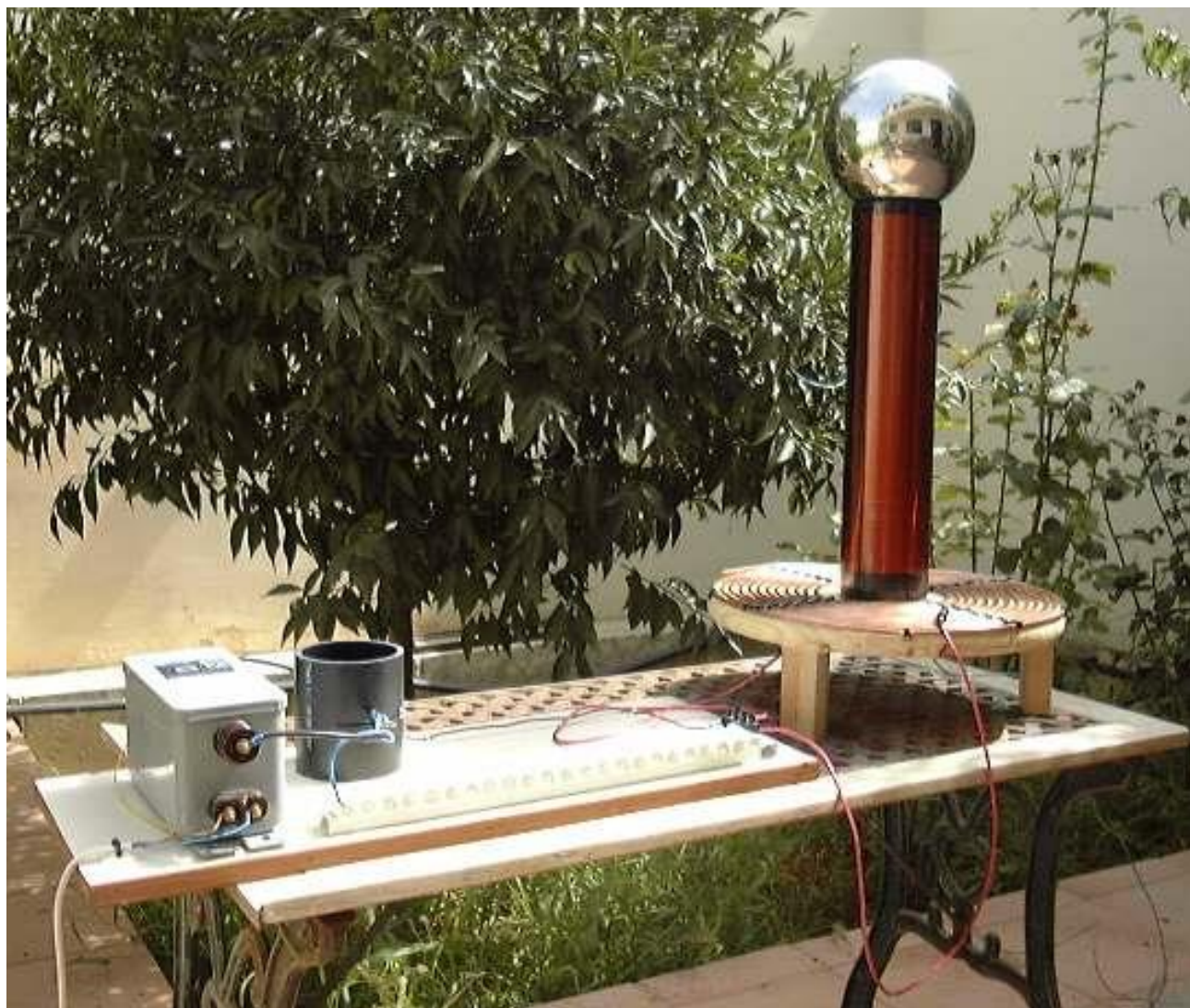
شکل (28). راه اندازی نمونه آزمایشگاهی ترانسفورمر تشدید
