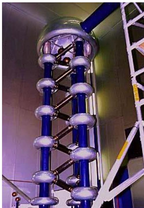
شکل (19). نمونه‌ای از مدار Cockcroft Walton (CW) برای تولید ولتاژ در حد مگاولت
